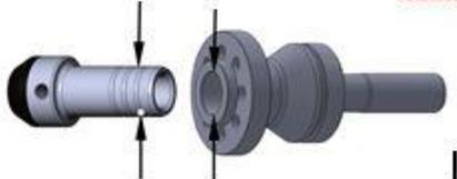
**La Culata:** asegúrese de sacar toda la grasa de la rosca de conexión con la tubería. Humedad puede entrar en la en la grasa y causar corrosión en la superficie. Revise que no hayan aberturas en las roscas y compárelas con una rosca nueva. Si el desgaste es
