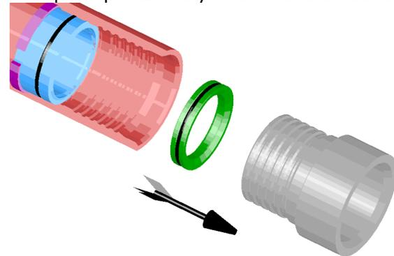
6. Solo el martillo RH80Q usa cojinete. Para el martillo RH80R anda al proximo passo. Saque el rodamiento (cojinete). Un "o-ring" alrededor del rodamiento es lo único que lo agarrará. Debería poder sacarlo con la mano, pero a veces queda pegado y debe ser sacado con un golpe leve de un martillo especial.
