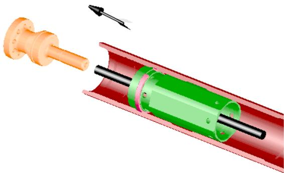
8. Saque el cilindro y el pistón. Ponga la camisa en el lado de la culata y el pistón caerá contra el cilindro. Usando una barra pesada (2-1/2 diámetro x 40" de largo), golpee el pistón para sacarlo. Ponga la camisa horizontal y remueva el cilindro y el pistón empujándolos.
