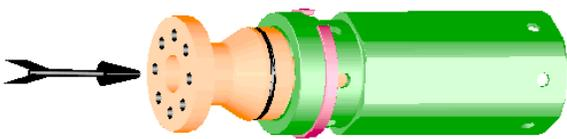
6A. Instalando el cilindro y el distribuidor de aire sin el arramiento Rock Hog #45421. Se requiere unas alicates con cadena y un anillo simple de metalico para proteger las roscas y dejar pasar el anillo de retenedor del cilindro. (6.215/6.210 OD x 5.940/5.945 ID x 1-1/4" ancha).
