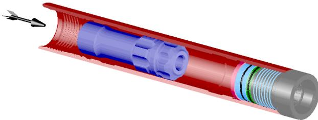
6. Aplique aceite o grasa en el o-ring de la distribuidor de aire. Ponga la distribuidor por encima del cilindro y golpee suavemente para que entra en el cilindro.
