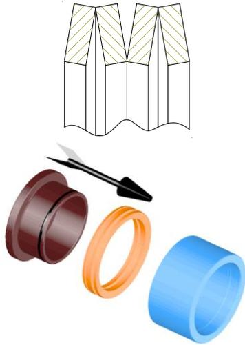
Coloque el resorte de discos, en el anillo de espacio para abajo. (Hacia el distribuidor de aire). **EL ANILLO DE ESPACIO DEBE ESTAR PARA ABAJO PARA DEJAR FUNZIONAR EL RESORTE.**
