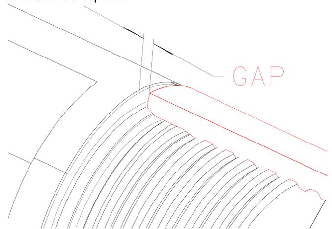
10. Despues que hay un espacio correct, saque la culata, ponga la Arandela de breakout, y un o-ring en la culata. Aplique la grasa de cobre en la rosca de la culata y enrosque la culata con la fuerza de mano. Si hay, ponga el protector de plástico en la rosca exterior de la culata.
