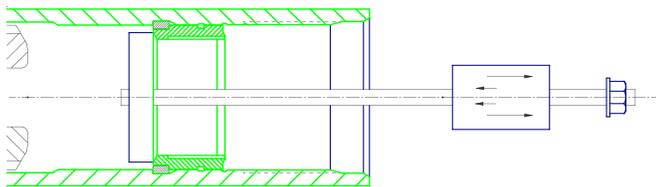
7. Saque el distribuidor de aire del lado de la portabroca con una barra de acero o un tubo (1-1/2" max dia x 30" min larga). Coloquela barra a través del pistón para sacar el distribuidor de aire.
